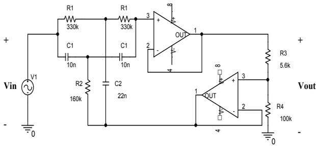
그림 5 Twin-T notch 필터의 구조
