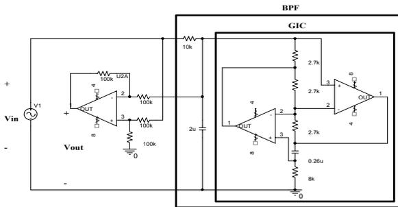
그림 6 GIC를 이용한 Notch 필터의 구조
